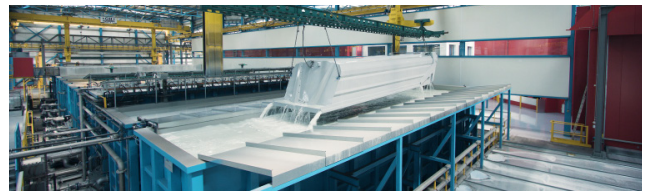
KLT: Protección anti corrosión en chasis y caja por cataforesis
