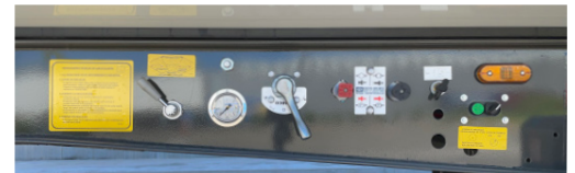
Suspensión de tres posiciones y ayuda a la tracción
