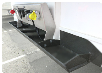
Support de connexions en inox et butoir avant de protection extra large et renforcé
